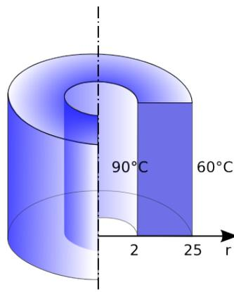
Abbildung 10: Schematische Skizze des Wasserbades ( $r$  in cm).
